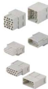
Złącza sygnałowe od 6 do 25 pinów 40 A - 16 A 0,14 mm 2 - 6 mm 2
