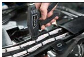
Opaska może być obcięta w dowolnym miejscu.
