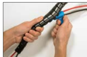
Jednym pociągnięciem narzędzia wprowadź przewody do węża Helawrap na całej długości.
