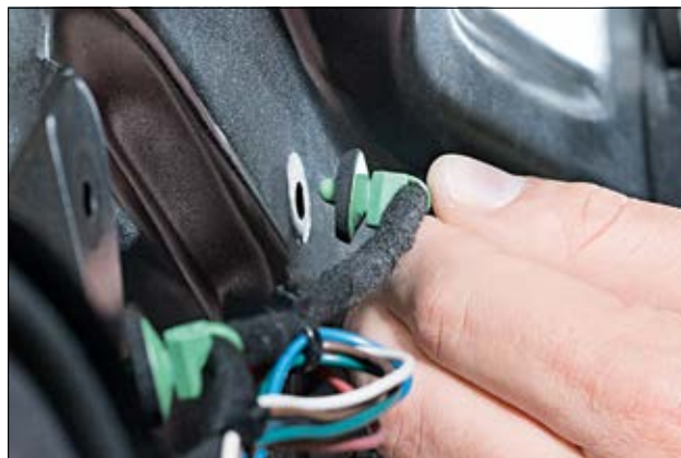
Uszczelka chroni otwór montażowy przed wnikaniem wilgoci.
