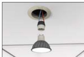
3. Włóż lampę do gniazda i zablokuj ją w prawidłowym położeniu.
