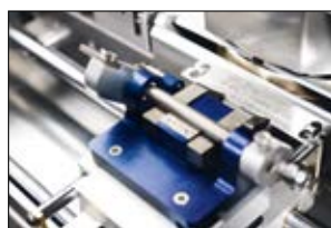
Proces wytłaczania oznaczeń na drukarce M-BOSS Compact.
