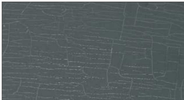
Struktura materiału została uszkodzona na wskroś przez promieniowanie UV.
