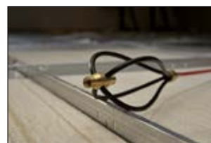
Trzepaczka ułatwia przeciąganie przewodu po nierównej powierzchni.
