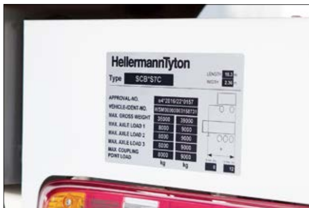
Tabliczka znamionowa przyczepy ciężarowej z laminatem ochronnym.
