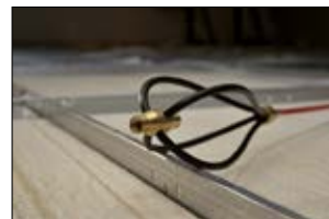
Trzepaczka ułatwia przeciąganie przewodu po nierównej powierzchni.
