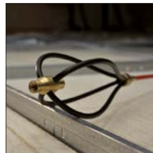
Trzepaczka ułatwia przeciąganie przewodu po nierównej powierzchni.
